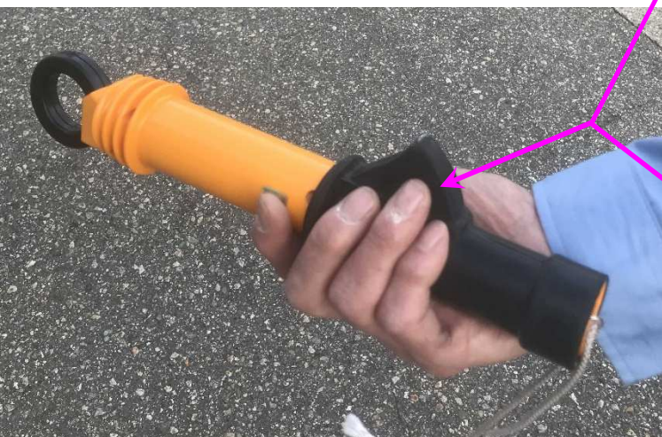
写真8 クランプ計操作（レンジ切替）時の指位置
